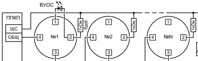
Рис.1 Типовая схема подключения извещателей к ППКП со знакопостоянным ШС. Величина резистора Rок определяется в соответствии с техническим описанием ППКП. Добавочный резистор Rдоб устанавливается – 1 кОм.
