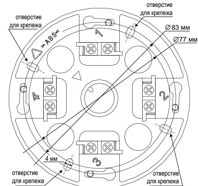
Рис.4 Базовое основание извещателя.
